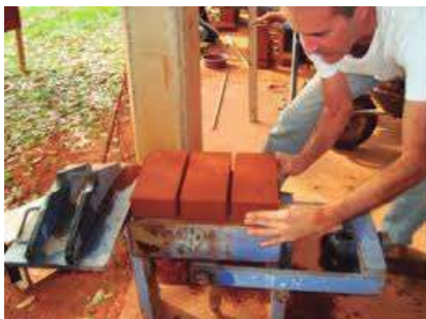
Foto 7: Prensa para fabricar o Bloco Solo cimento
