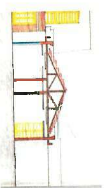
SITUAÇÃO REBAIXAMENTO O DO FORRO ENCONTRADA EM AGOSTO DE 2015
