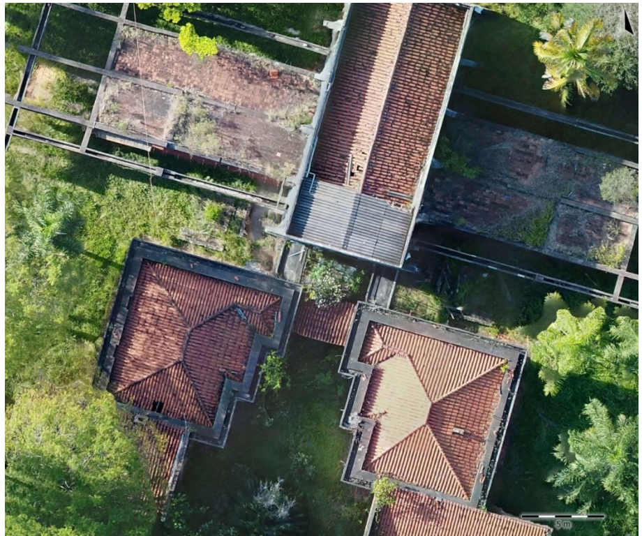
Imagem 15. Fazenda Capuava, 2025. Acervo: Brasil Restauro®. Ortofoto ampliada dos telhados. Nota-se perda de telhamento colonial sobre o corpo central trapezoidal e substituição de parte do telhamento por amianto – área com maior incidência de água pluvial, com impacto direto em forro de gesso, chapa de alumínio e mezanino.
